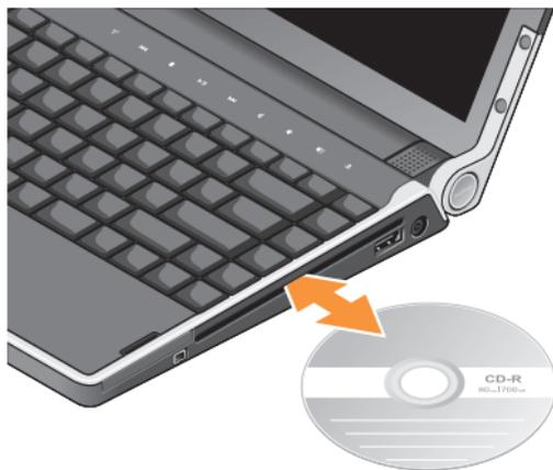
要使光盘从光驱中弹出，轻轻按下弹出控件
